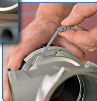
Inserire il cavetto di blocco nell'apposito foro sul corpo del raccordo e spingere fino a sentire il "click" che indica l'avvenuto bloccaggio.
